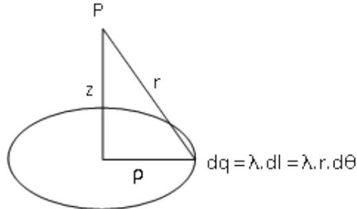
Figura 4.2: Anel isolante carregado com densidade linear  $\lambda$
